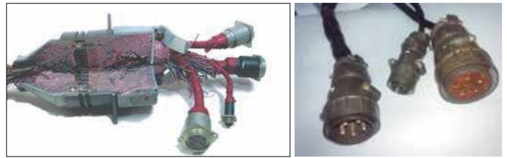
7 Пример применения двухкомпонентного компаунда Виксинт У-2-28
